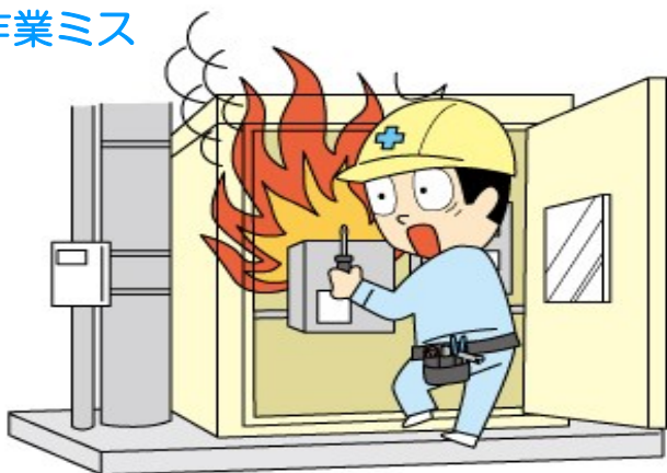
分電盤設置もしくは取替え作業中に作業ミスによりボヤが発生した。
